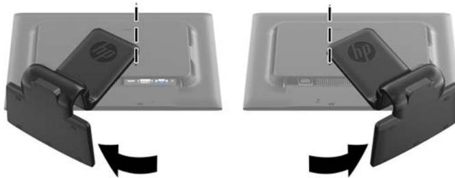
4. Putar alas monitor ke atas (1) kemudian tarik alas tersebut ke belakang (2) untuk melepas tab pada engsel dudukan monitor dari slot pada monitor.
